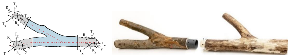
Abbildung 3: (Links) Beispiel eines biegesteifen Knotens in Form einer Astgabel mit ausgelösten Schnittgrößen. (Rechts): Biegesteifer Knoten durch Stahlring und Vollgewindeschrauben.
